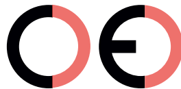
Falsche CE-Kennzeichnung (zu großer Zwischenraum)
